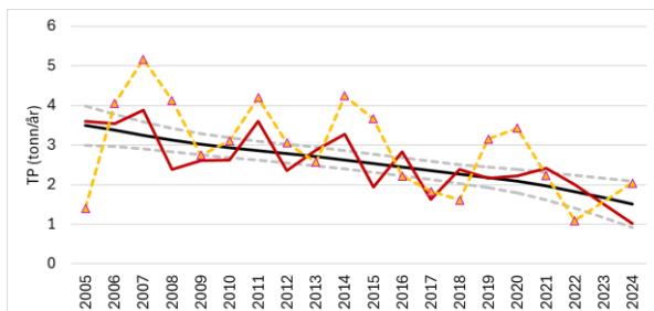
Tilførslene av fosfor (TP, tonn/år) samlet fra seks bekker til vestre Vansjø. Rød linje: Vannføringsnormaliserte tilførsler. Gul linje: Målte tilførsler. Svart linje: Trend (signifikant nedadgående).
